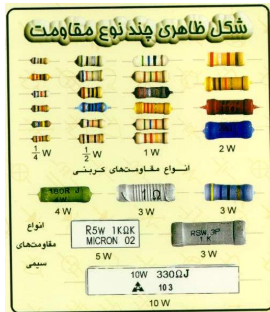
شکل-ج-۱ شکل ظاهری چند نوع مقاومت. تقسیم‌بندی مقاومت‌ها براساس توان مصرفی آنها می‌باشد.
